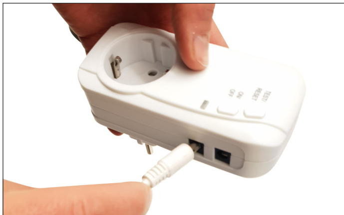
Inkoppling av ventilen görs på höger sida av enheten (2 st ventiler kan anslutas)
